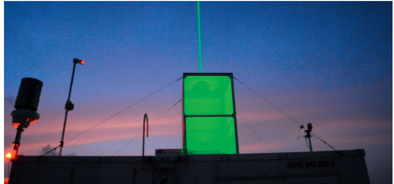
Einsatz eines Lidar-Geräts zur Vermessung von Wolken.
